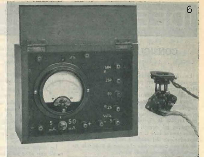
Fig. 6. Uno strumento di misura completato con le resistenze necessarie per la misura di tensioni e di correnti di diversi valori.
